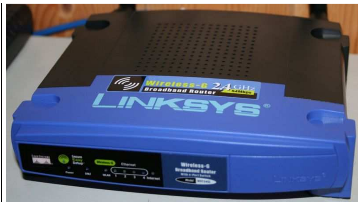
8. Punkt dostępowy Linksys WRT54GL na pasmo 2,4 GHz
